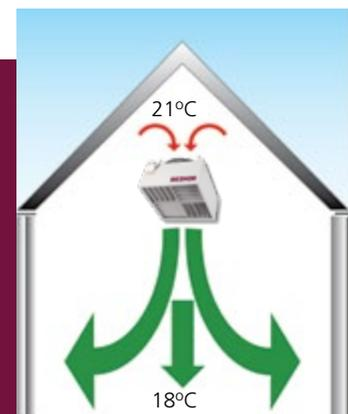
Le DS recircule l'air chaud au niveau de sol: le confort est amélioré et les coûts d'exploitation réduits.
